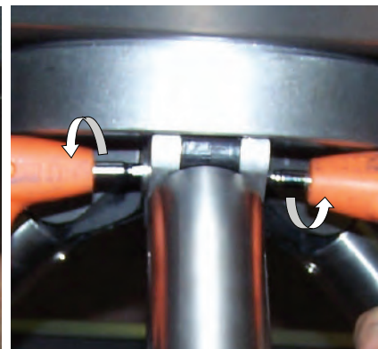
3. Затяните винты (шестигранник 5 мм)
