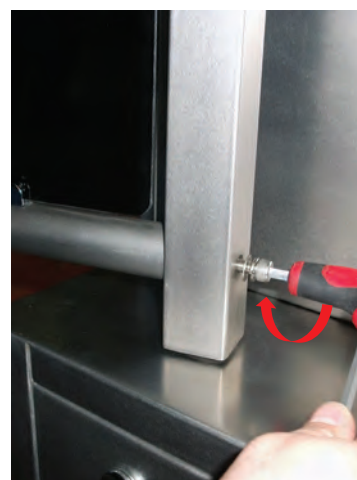
3. Затяните нижний винт
